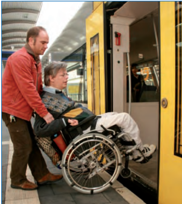
Abbildung 134: Hier gibt es zwar einen nahezu höhengleichen Einstieg, doch die Überwindung des Restspaltes ist nur durch fremde Hilfe möglich
