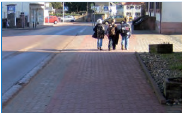
Abbildung 21, Abbildung 22: Trennstreifen bzw. Sicherheitsraum (grau) auf Gehwegniveau – der Trennstreifen/Sicherheitsraum ist dem Gehweg zugehörig; in der Regel wird er daher auch in gleichem Material und Farbe angelegt (Landkreis Kaiserslautern)
