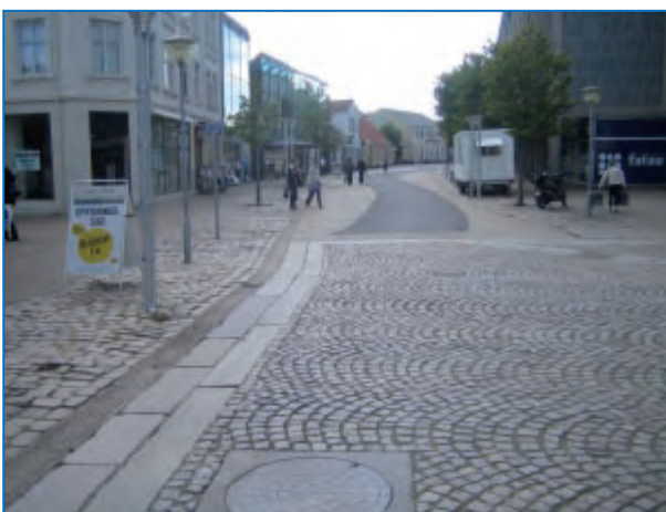
Abbildung 2, Abbildung 3: Innerstädtischer (historischer) Straßenraum mit weicher Trennung: die „Fahrgasse“ ist optisch und taktil zu erkennen, für Rollstuhlnutzer sind die mittlere (unteres Foto) bzw. die mittlere und äußeren Flächen gut nutzbar (Hjoring, Dänemark)
