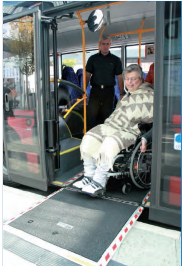
Abbildung 135: Einstieg mit klappbarer Fahrzeugrampe bei einem Niederflrbus und erhöhtem Bord (mit nur noch kleiner Reststufenhöhe und Spaltbreite)
