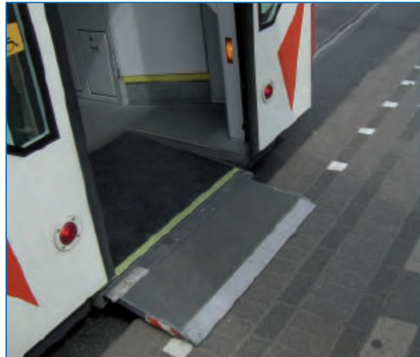
Abbildung 133: Einstieg an einer Straßenbahnhaltestelle mit automatischer Rampe zur Spalt- und Höhenüberbrückung (Mainz)
