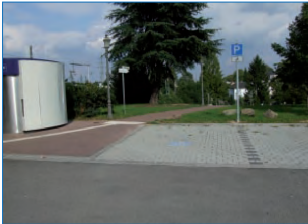
Abbildung 101: Behindertenparkplatz mit 3,50 m Breite und 5,00 m Länge (Eltville) 255
