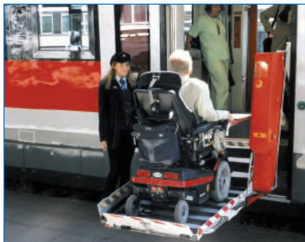
Abbildung 145: Einstieg in ein Regionalfahrzeug mit Hublift auf einer Strecke des RMV
