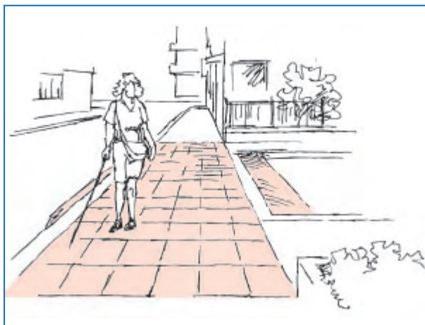
Abbildung 43, Abbildung 44: Schemazeichnungen für Aufpflasterung einer Gehwegüberfahrt aus einem Wohnweg, um angenehmes Überqueren der Einmündungen zu ermöglichen 72
