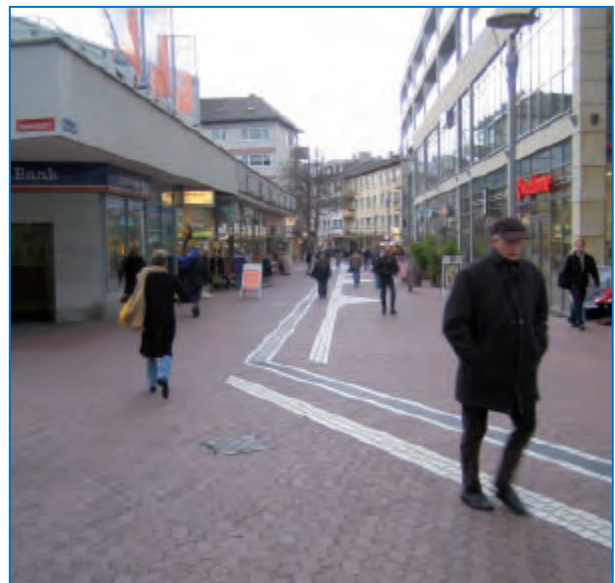
Abbildung 13, Abbildung 14: Sichtbare und ertastbare Verdeutlichung von Fußwegeachsen und Blickachsen; hier wird das (Blinden-)Leitsystem in die Stadtgestaltung integriert. Auch Details sind hier gut gelöst: Das Leitsystem hebt sich vom angrenzenden Bodenbelag ab, die Poller sind kontrastreich markiert (Marburg, Mainz)
