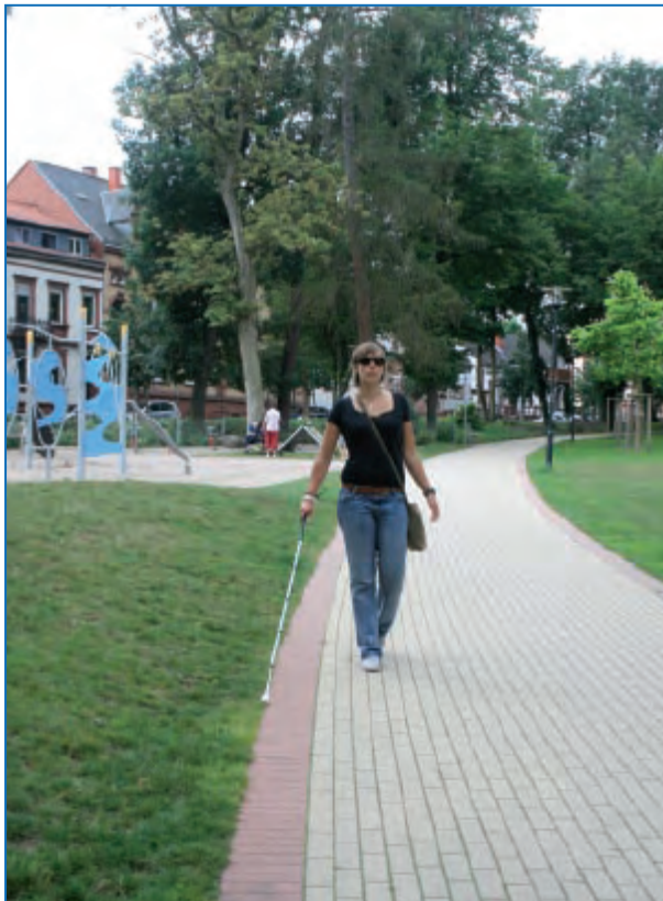
Abbildung 174: Ausreichend breiter Hauptgehweg mit geringer Steigung, kontrastreicher Gestaltung sowie ausreichender Beleuchtung; im Hintergrund barrierefrei erreichbare Spielmöglichkeiten
