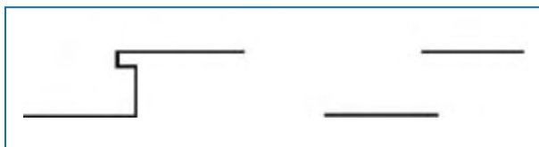
Abbildung 2: Unzulässige Stufengestaltung mit Hervorkragung (links) und ohne Setzstufen (rechts)
