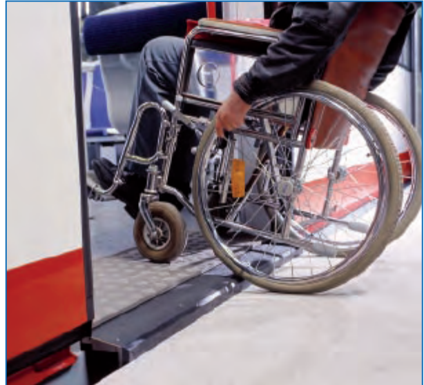
Abbildung 142: Schiebetritt zur Spaltüberbrückung an einer neuen U-Bahn (Nürnberg) 373
